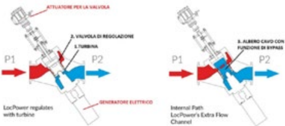
Figura 40_Funzionamento dei dispositivi LocPower
